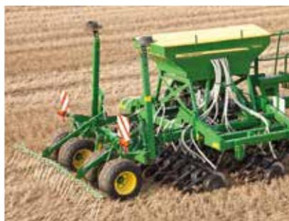
Le semoir de semis direct qui peut être à dents ou à disques.
